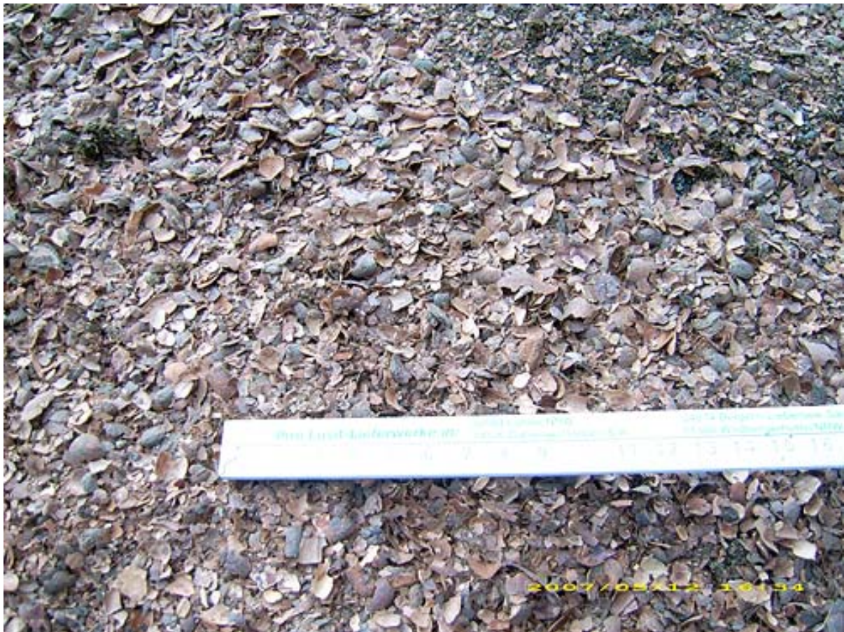
Bild 7: CACOA, Bodenverbesserung mit Kakaoschalen 0/ 18 mm
