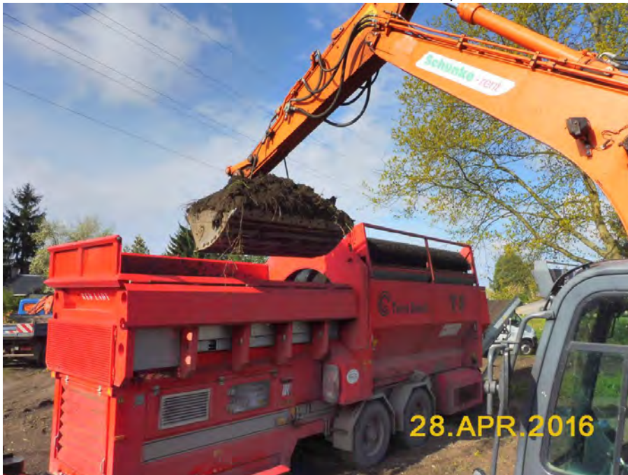
Bild 3: Mobile Siebanlage mit einer 10 mm Maschenweite
